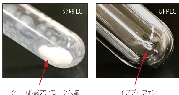
図5 イブプロフェン画分の乾燥後の状態
