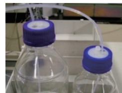
図4 移動相容器用キャップの例
