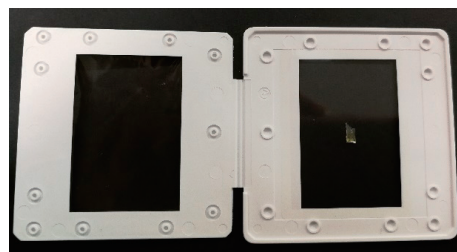
図4-1 EDXIR-Holderに異物を貼り付けた様子
