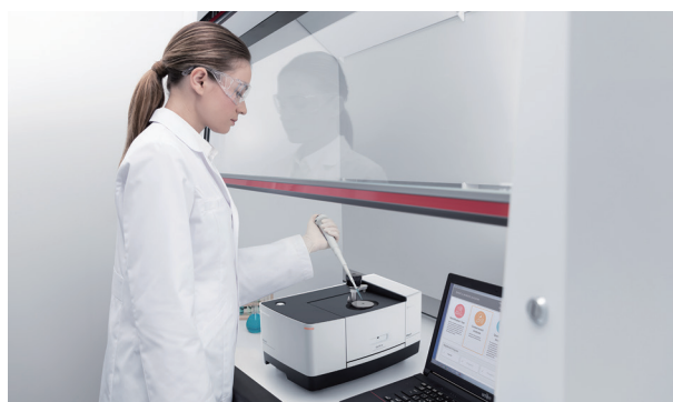
図2 ドラフト内に設置した IRSpirit (試料室一体型の ATR 測定装置を搭載)
