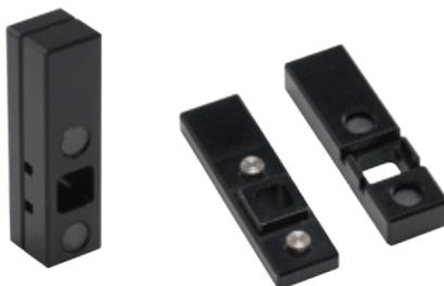
図10 セル型試料ホルダ
