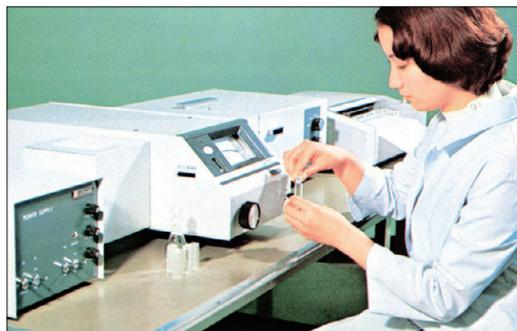
図4 島津紫外可視分光光度計UV-200型
