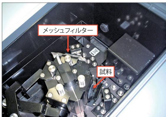
図7 試料(PET容器)の測定状況
