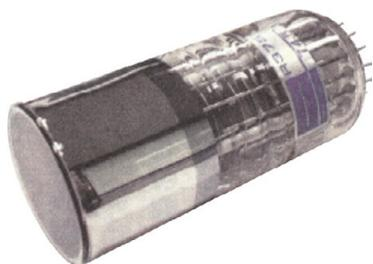
図9 エンドオン型光電子増倍管
