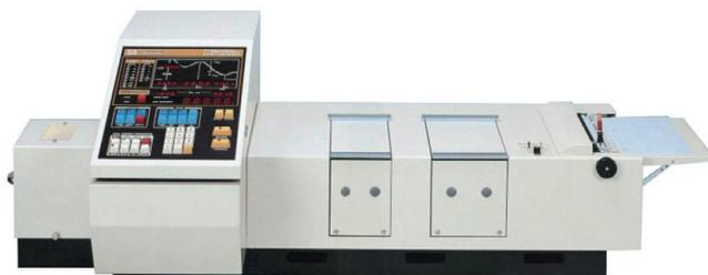
図11 島津二波長/ダブルビーム自記分光光度計UV-3000型
