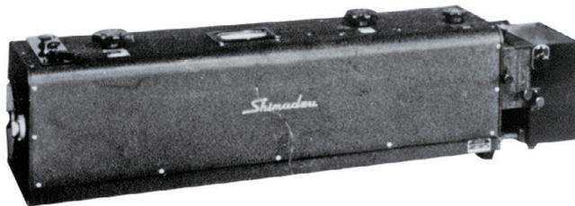
図2 島津紫外可視分光光度計QB-50型
