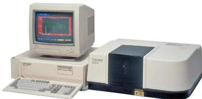
Fig. 7 島津フーリエ変換赤外分光光度計FTIR-8100型
