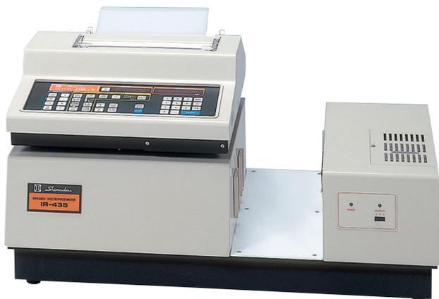
Fig. 5 島津ダブルビーム自記赤外分光光度計型IR-435型
