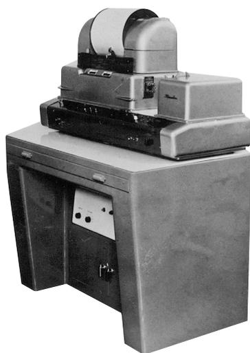
Fig.2 島津ダブルビーム自記赤外分光光度計AR-275
