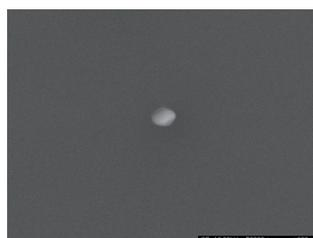
図 19 チタン酸バリウム粒子のSE像
