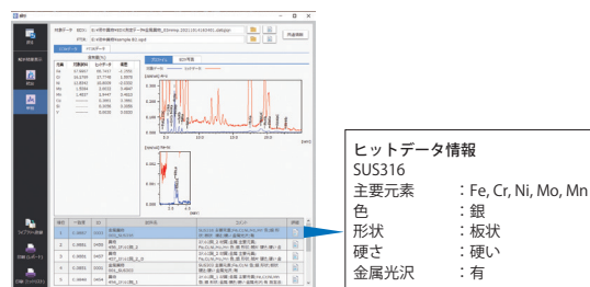
図30 異物BのEDX単独解析結果
