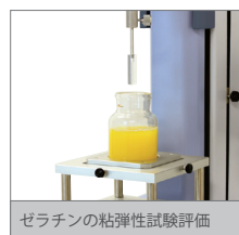
ゼラチンの粘弾性試験評価
