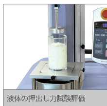
液体の押出し力試験評価
