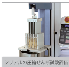
豆の圧縮せん断試験評価
