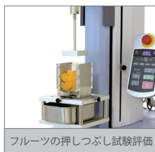
フルーツの押しつぶし試験評価
