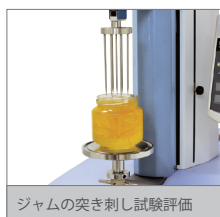
ジャムの突き刺し試験評価
