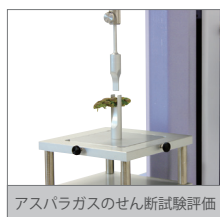
アスパラガスのせん断試験評価
