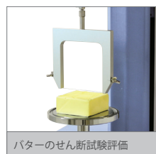
バターのせん断試験評価
