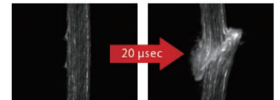
高速ビデオカメラによるGFRPの圧縮挙動の可視化
