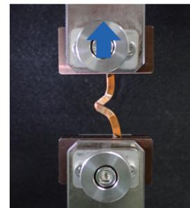
ステーターコイルの引きはがし試験の様子
