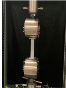
熱可塑性エポキシ樹脂をベースとした幅6~8mmのUDテープを、長さ6.5mm、13.0mm、26mmに切断し、繊維方向を様々な方向に配向させた後、プレス成形により厚さ3mmのランダム配向熱可塑性CFRP板を3種類作成しました。各CFRP板から、長さ250mm、幅25mmの試験片を切り出して評価を行いました。引張試験の際には#600番の布やすりを試験片把持部とつかみ具のつかみ歯の間に挿入する、仮想タブを用いた試験法を採用しました。UDテープの長さによらず、チャック切れなく標定部で引張破壊させることができました。
