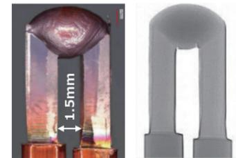
プロファイル制御技術を利用し、隣り合うワークそれぞれの中心にレーザー光が当たるようにプロファイル制御を行いました。これにより、各ワークに対して過剰な熱エネルギーを与えることなく加工ができ、不要な部分への光照射を抑えることで、絶縁被覆部への熱影響を最小限に抑えることができます。また、線間ギャップが1.5mmという大きな隙間があっても、良好な溶接結果が得られています。
