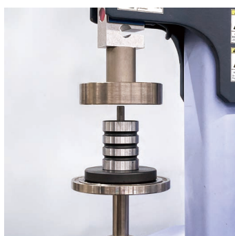
上部：固定式圧盤φ100 mm 下部：下圧盤φ118 mm
