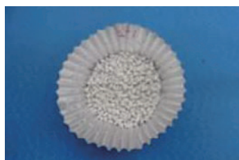
図7 樹脂ペレットを恒温槽に入れる前の状態
