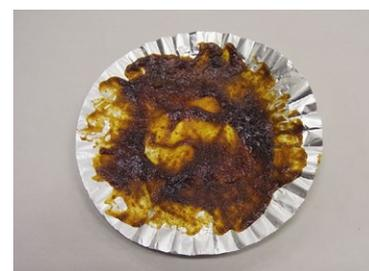
\*水分率を測定する方法として、公定試験法の乾燥減量法があります。この方法で水分を含んだ試料の重さを測定し、恒温槽で水分を蒸発させて試料の重さを再計測することで水分率を測定します。公定試験法では、乾燥温度を100℃前後として3~5時間放置させて乾燥させます。
