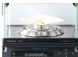
薬包紙のような、皿径より大きな風袋でも専用のマルチスタンドを取り付けることにより、簡単に計量できます。
