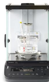
可動式風防内部プレートを取り外せば、比重測定キット(SMK-601)にも対応。
