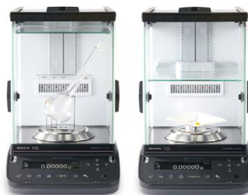
5 mm 単位で高さ調整が可能。使用する容器や試料に応じて高さを調整し、ひょう量室内を最適な状態にします。
