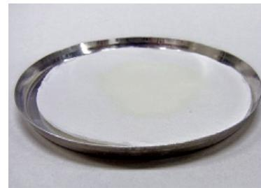
(測定後) 牛乳の水分が蒸発し、残った脂肪分がわずかに黄色く変色しています。
