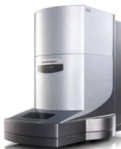
従来のSPMよりも短時間で表面形状観察ができます。試料やカンチレバーの交換が容易となり、セッティングから観察までのトータルスルーの向上を支援します。測定試料数が多い場合や、定形の繰り返し観察に最適です。
