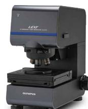
ナノに迫る高分解能観察と高精度測定を非接触・高速で行えます。専用対物レンズと専用光学系により急傾斜部形状や反射率の異なる材料などでも確実に測定が行えます。最新三次元性状パラメータ(表面粗さ)にも対応。ISO 25178-2:2012、JIS B0681-2:2018に準拠しています。
