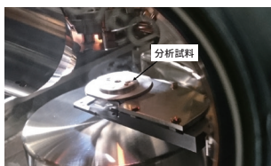
大型ビューポートから観察したサンプルホルダーと試料（分析室内）
