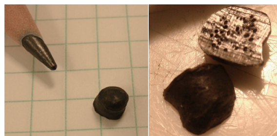
図28 5 mm程度のプラスチックペレット（左）と断面の様子（右）
