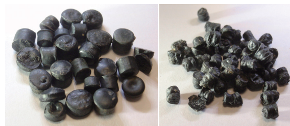
図29 未使用（左）と使用済（右）のプラスチックペレット
