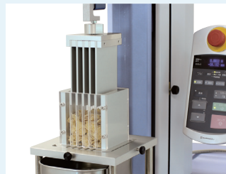
シリアルの圧縮せん断試験
