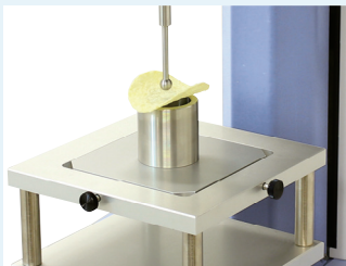
ポテトチップスの破断力試験
