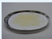
(測定前) グラスファイバーシート上に試料を載せて、ヘラで均一に広げました。
