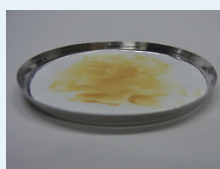
(測定後) グラスファイバーによりマヨネーズの乾燥する表面積が増え、均一に乾燥させることができました。
