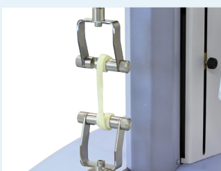
麺類の引張・せん断試験
