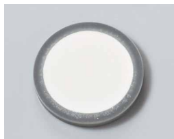
プレス機などで加圧成形する (ブリケット・プレス法)
