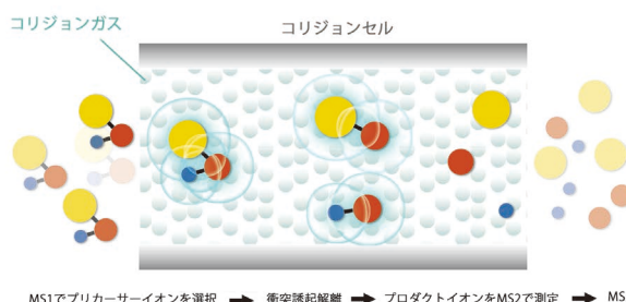
図29 MS/MSシステムのコリジョンセル内部で生じるCIDの模式図
