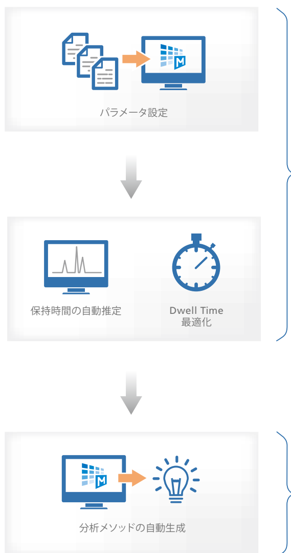
図39 MRM最適化ツール MRMメソッド開発の効率及び精度を向上
