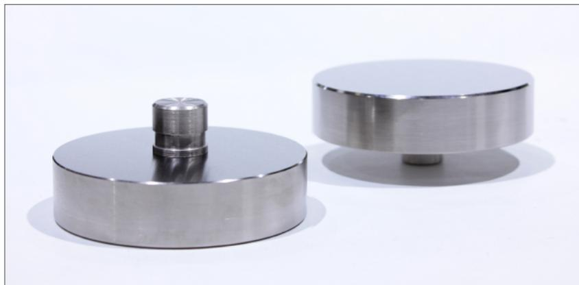
固定式圧盤は（別名プラテンとしても知られる汎用試験用のアクセサリーで）、さまざまな材料や製品の圧縮（サイクル）試験に使用できます。表面は、ロックウェル硬さ（HRCスケール）60の高硬度のため、摩耗が非常に少なく表面の平滑性を維持できます。
