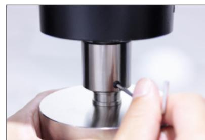
継手と圧盤の連結とねじによる固定
