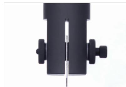
ブッシュによる試験片と試験軸の位置合わせ
