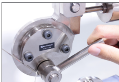
溝に沿って半周巻き付けます。
