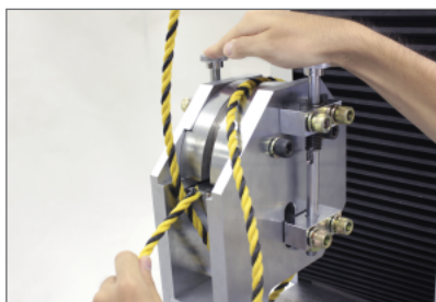
ロープの取り付け
