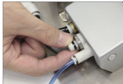
空気圧調節ねじでつかみ力を変更できます。
