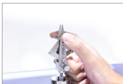
ばね機構による自己締まり作用
