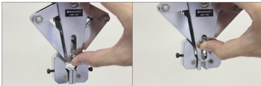
支点軸を上下動させ、つかみ具を開閉
