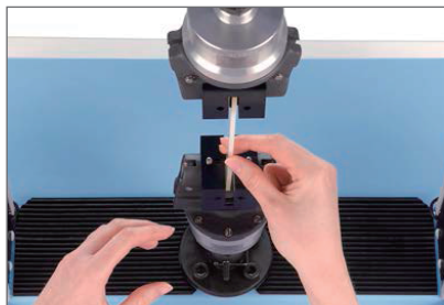
手を使わないフットバルブユニットでは両手で試験片の取り付けが可能
