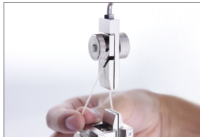
V字切り込みがあり、 上部つかみ具への糸の取り付けに便利
