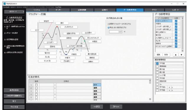
食品、医薬品の特性（テクスチャー）を測定するソフトウェアです。そしゃく性、ゼリー強度、粘着性など、専用のデータ処理結果を求めることができます。
