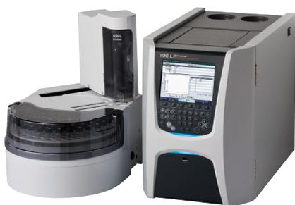
4 µg/L~30,000 mg/Lの超ワイドレンジを備えた燃焼式TOC計です。超純水から高汚濁水まで適用可能な、高感度と強力な有機物酸化力を両立したTOC計です。
