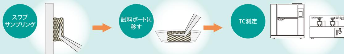
スワブ/直接燃焼炭素測定法による残留物評価の手順(詳細については、お問い合わせください)
