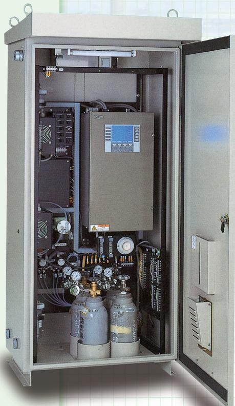
燃焼設備などの排ガス中には、 $\text{NO}_x$ 、 $\text{SO}_2$ 、 $\text{CO}$ 、 $\text{CO}_2$ 、 $\text{CH}_4$ 、 $\text{O}_2$ 、 $\text{N}_2$ などのガスが含まれています。これらの排ガス中の $\text{NO}_x$ 、 $\text{SO}_2$ は大気汚染の原因となるため、早くから濃度測定が実施されています。また、近年、高い燃焼効率と低公害を同時に実現するために $\text{CO}$ 、 $\text{CO}_2$ 、 $\text{O}_2$ の濃度測定の要求が増大してきています。
