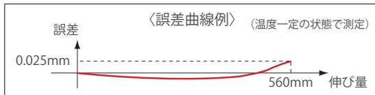
SIE-560Aには伸び計専用開発した高精度な磁気誘導式リニアセンサーが採用されています。このセンサーは小型軽量かつ高い再現性を備えており、伸び量の小さい領域はもちろん、伸び量の大きい領域(最大ストローク560mm)においても、従来のセンサーに比べて飛躍的に高い測定精度を実現しています。金属などの弾性率や破断伸びの高精度測定を、1台の伸び計で1度の試験によって行うことが可能です。
