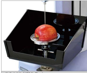
③突き刺し試験治具 φ3mm
