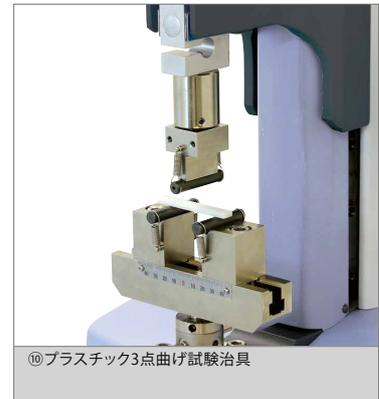
⑩ プラスチック3点曲げ試験治具
