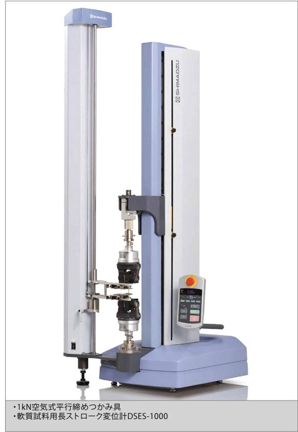
・1kN空気式平行締めつかみ具
