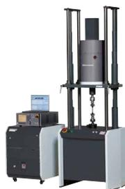
電磁力式微小試験機
