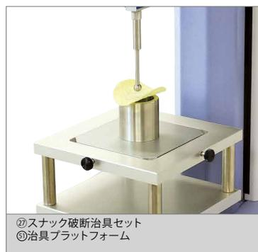
㉑スナック破断治具セット
