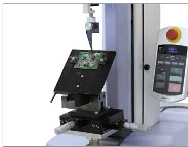
⑩プリント基板剥離試験治具セット
