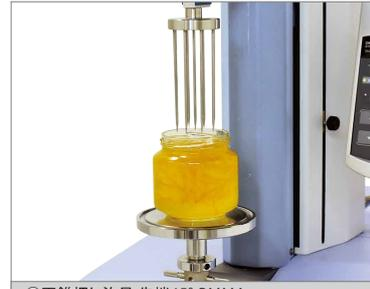
⑤円錐押し治具 先端45° PMMA
