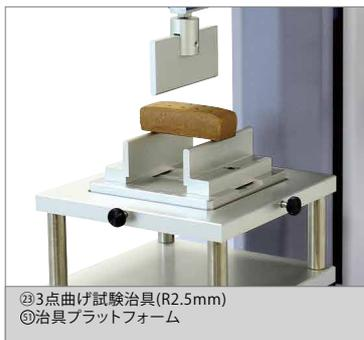
⑳3点曲げ試験治具(R2.5mm)
