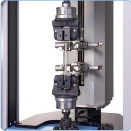
標点位置の検出、標点間距離の設定、試験片へのアーム着脱が自動で行えます。
