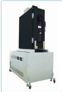
降温を冷凍機で行うため、低温試験を頻繁に行う用途に適しています。温度範囲により、TCR1形とTCR2形があります。
