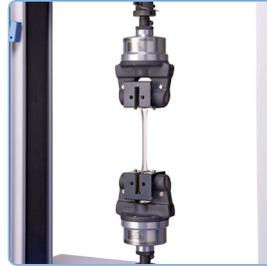
フットバルブやフットスイッチにより、つかみ歯の開閉が行えます。試験機本体との連動も可能です（オプション）。試験片の厚みが減少しても、一定の締め付け力が得られます。
