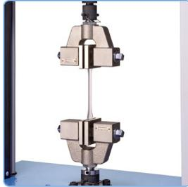
試験片の厚さや太さに応じて片方のつかみ歯の位置をあらかじめ調節しておけば、もう片方のつかみ歯の操作だけで試験片を着脱できます。
