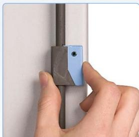
つまんで移動、はなして固定。クロスヘッドストロークのリミット位置を、ワンタッチで調節できる上、確実に固定できます。
