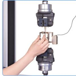
軽量・小型の伸び計で、試験片への着脱がワンタッチで行えます。
