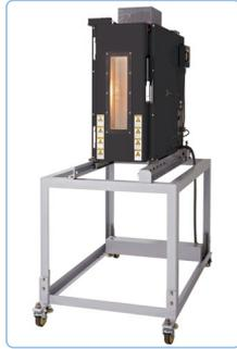
液体窒素や炭酸ガスを吹き付けることにより降温します。冷凍機式よりもさらに低温の試験環境を作ることができます。
