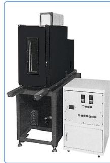
繊維、紙、フィルムなど、その機械的性質が温度と湿度に影響されやすい材料の試験に最適です。温度調節：ヒータと冷凍機による自動制御方式
