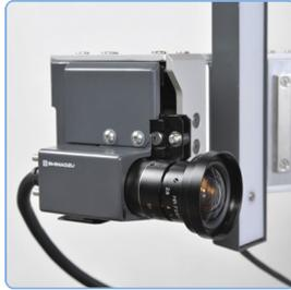
CCDカメラで撮影した画像をもとに、試験片の標点間伸びを測定します。高精度、広範囲の伸び測定ができます。
