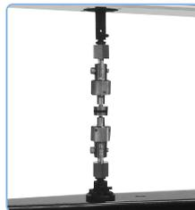
2枚の平行な金属板に接着したゴムのはく離試験が行えます。JIS K6256、JIS K6250、ASTM D429 に適合した、はく離試験治具です。
