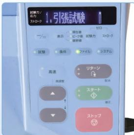
本体の操作パネルから制御用ソフトウェアの試験条件を呼び出し、試験を実施できます。もちろんスタンドアロン機として、本体のみでも試験条件の作成、試験の実施ができます。
