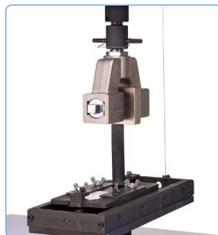
上部つかみ具の動きに連動して試料テーブルがスライドし、90°の引きはがし角度を保持します。JIS Z0237、JIS Z1528 に適合した引きはがし試験治具です。
