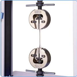
くさび作用により、小さな締め付け力で大きな保持力が得られます。最もポピュラーなつかみ具です。
