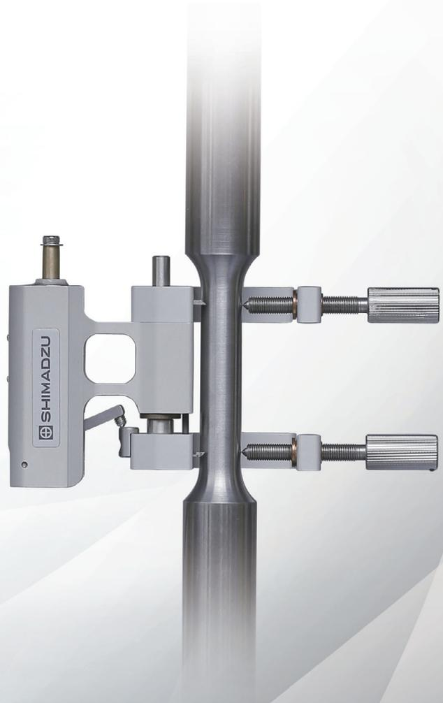
金属引張試験規格JIS Z 2241では耐力測定時の伸び計は2級以上、ISO 6892-1では等級1級以上と規定されています。伸び計DTシリーズは、伸び計等級1級に対応した差動トランス式伸び計であり、金属引張試験規格に対応した試験法が行えます。
