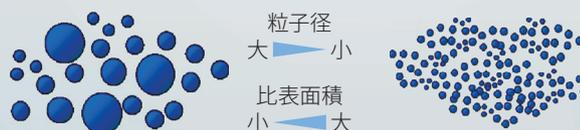
トータルの体積が同じでも粉体、粒子が微粒化すると比表面積は増加します。
