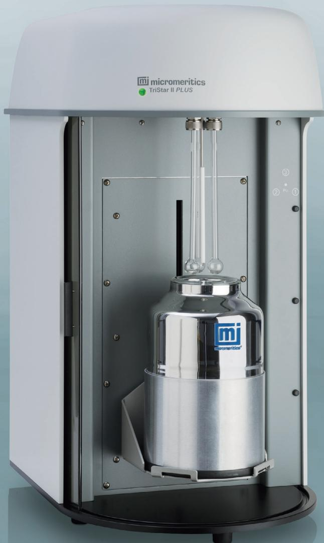
トライスター II Plus 3030は、ガス吸着法に基づく定容量により比表面積/細孔分布を求める装置です。3つの測定ポートを備え、同時かつ独立に自動測定が可能です。また、標準形とクリプトン対応形の2つのモデルがあり、測定対象や目的に応じて最適な1台を選択していただけます。
