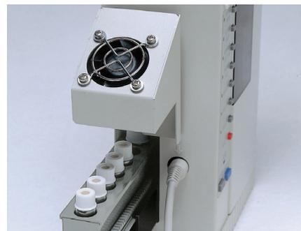
再現性の向上はもちろんのこと、新型ニードルガイドや注入シーケンスの見直しでシリンジの針曲がりをシャットアウト、シリンジクーリングファンを標準装備し、シリンジ温度を一定に保ちます。また、オプションの試料冷却用ファンを用いれば、試料気化室温度が高い分析でもターレットに並んだ試料の温度上昇を最小限におさえます。
