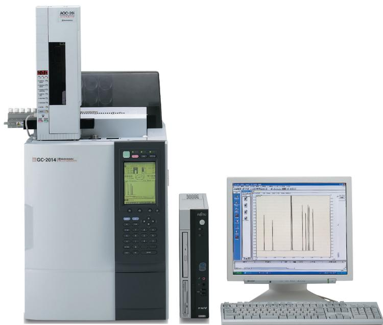
システムGCとは、石油化学、ガス製造プラントなどの品質・工程管理や、環境ガス分析および反応ガス研究などの分野向けに、ガスクロマトグラフにサンプル導入部、バルブなどを追加し、運用環境に合わせてカスタマイズしたシステムのことを指します。
