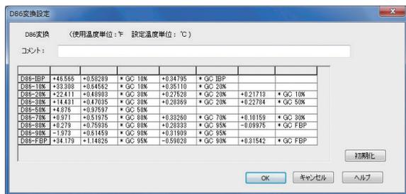
D86変換 (常圧法) の変換パラメータ設定画面
