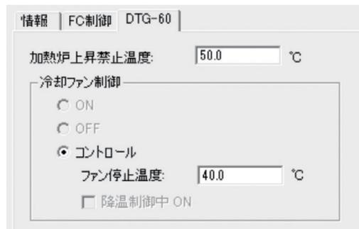
冷却ファン制御条件の設定(装置プロパティBOX)
