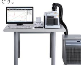
示差熱・熱重量同時測定装置 DTG
