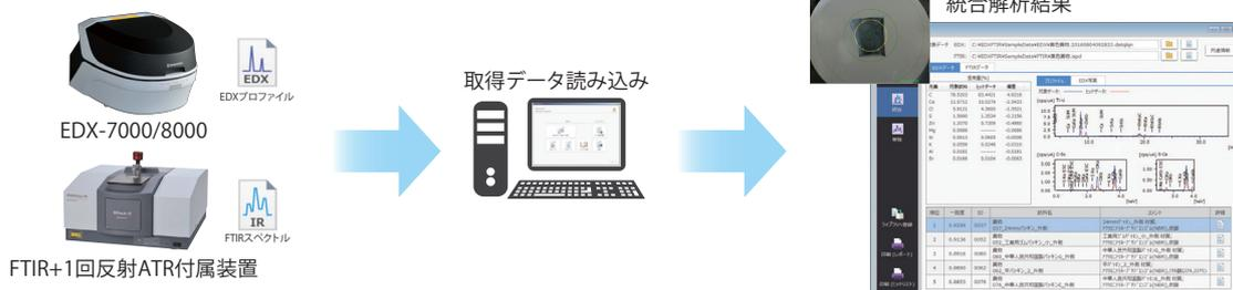
黒色ゴム状異物を分析して統合解析した事例です。統合解析の結果、黒色ゴム状異物は炭酸カルシウムとステアリン酸亜鉛を含有したNBR(アクリロニトリルブタジエンゴム)であることがわかりました。
