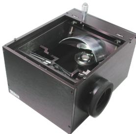
加熱真空拡散反射装置
