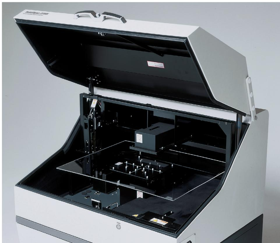
超大形試料室による幅700 mm×奥行560 mmの試料測定
