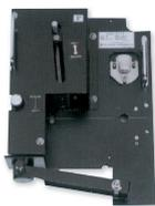
固体試料の絶対鏡面反射測定ができる装置です。適応試料サイズは20~150 mm角、厚さ30 mm以下です。
