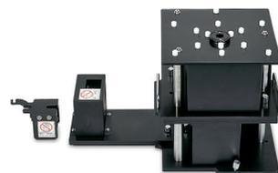
大形の試料の相対鏡面反射測定ができます。
