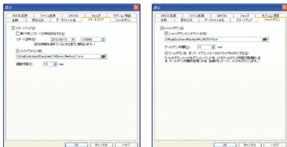
Fig.8:スタートアップ/シャットダウン機能 (バッチ設定画面)
