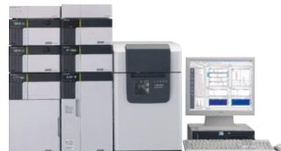
Fig.4: LCMS-2020システム
