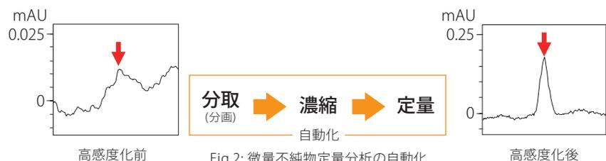
Fig.2: 微量不純物定量分析の自動化
