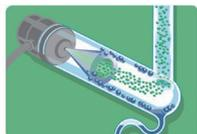
ガス流を利用して、移動相を微小な液滴にして噴霧する
