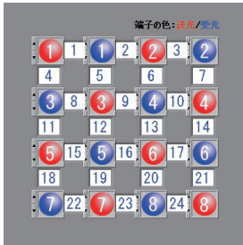
図4 送光用ファイバ(赤)と受光用ファイバ(青)の配置例(4×4、24チャンネル配置)
