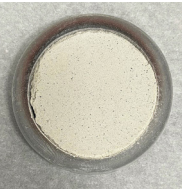
試料外観 (全圧250kN・30秒による加圧成形)
