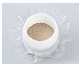
底面にフィルムを貼った試料容器に入れる(リースパウダー法)
