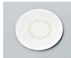
試料を専用のろ紙に滴下し乾燥 させた後に測定を行う
