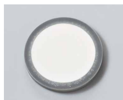
プレス機などで加圧成形する (プリケット-プレス法)
