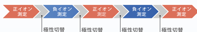
正イオンモードと負イオンモードの切り替えイメージ
